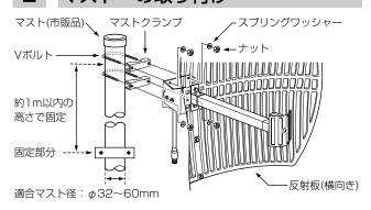
※風などでアンテナが揺れるのを防止するため、Vボルトの位 置は、マスト固定部分から、1m以内の高さに固定してくだ さい。
